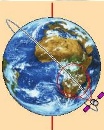
Рис. 3. Общий случай орбиты спутника с наклоном  $0^\circ < "i" < 90^\circ$ .
