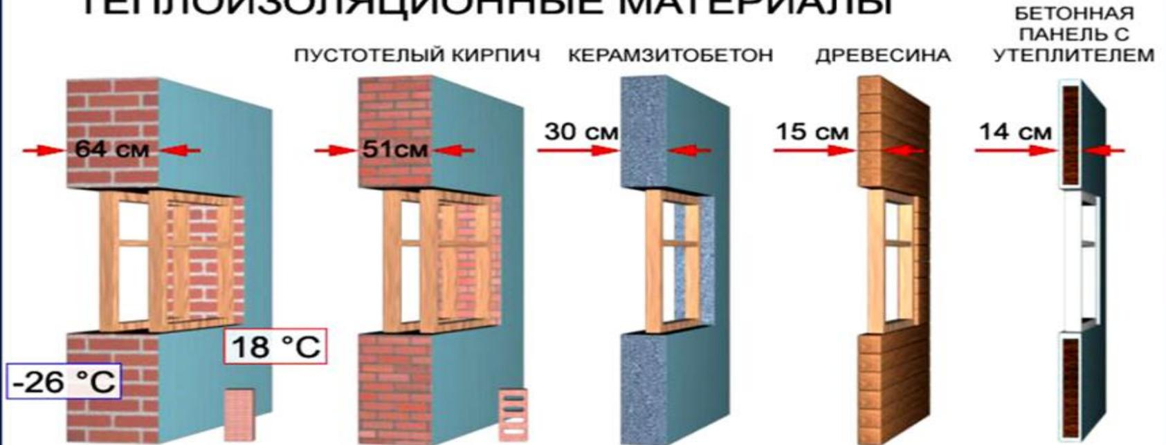
ШКАЛА ТОЛЩИНЫ МАТЕРИАЛОВ ПРИ ОДИНАКОВОЙ ТЕПЛОПРОВОДНОСТИ
