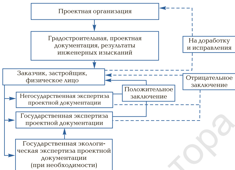
Рис. 1.5. Схема экспертизы проектной документации и результатов инженерных изысканий на капитальное строительство объектов
