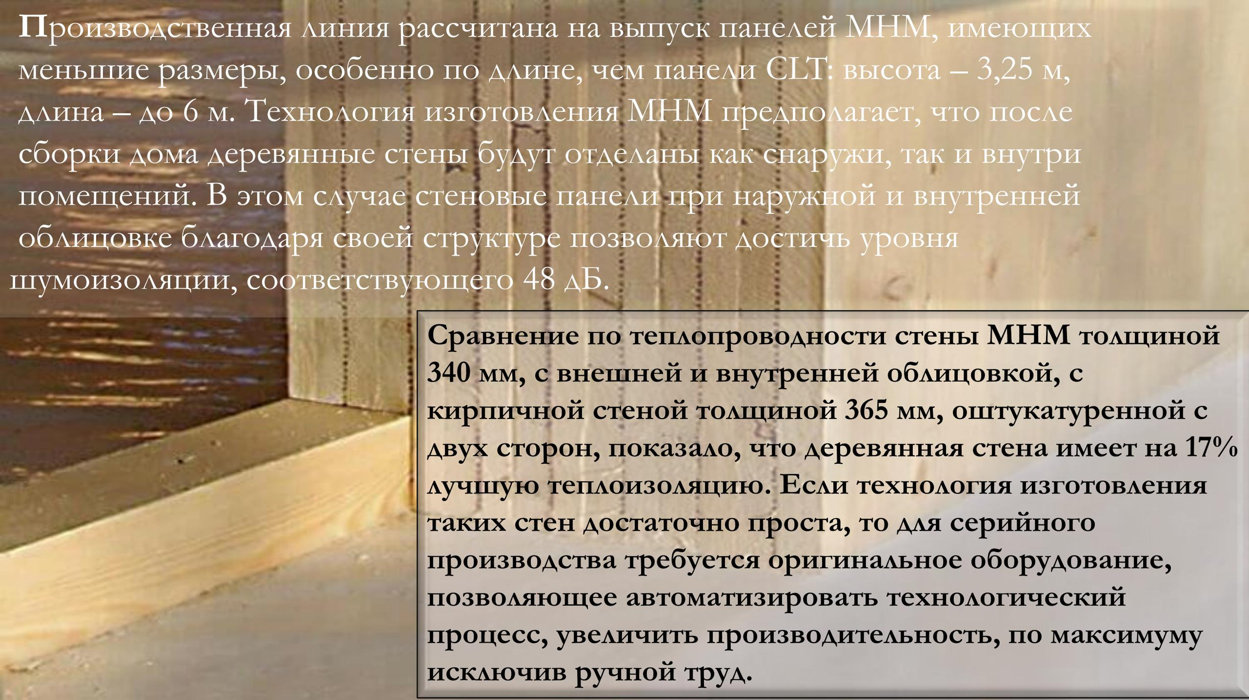
Производственная линия рассчитана на выпуск панелей МНМ, имеющих меньшие размеры, особенно по длине, чем панели СЛТ: высота – 3,25 м, длина – до 6 м. Технология изготовления МНМ предполагает, что после сборки дома деревянные стены будут отделаны как снаружи, так и внутри помещений. В этом случае стеновые панели при наружной и внутренней облицовке благодаря своей структуре позволяют достичь уровня шумоизоляции, соответствующего 48 дБ.
