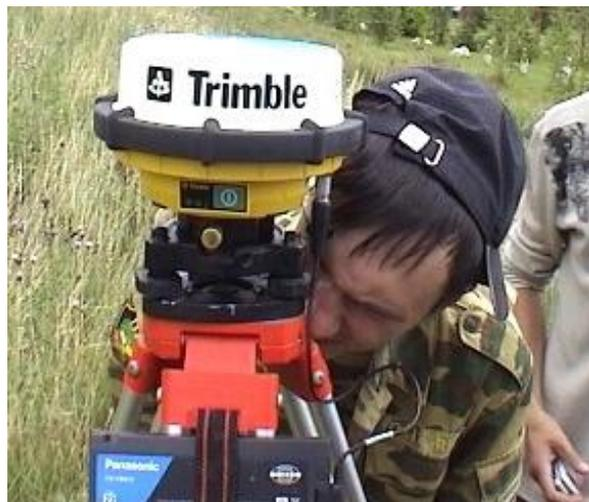
**Рис. 1.41. Проверка центрировки и ориентирование антенны на север**
