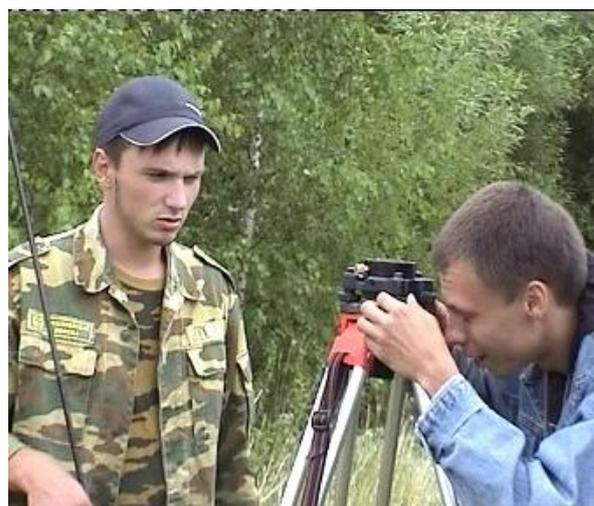
**Рис. 1.39. Центрирование и горизонтирование**
