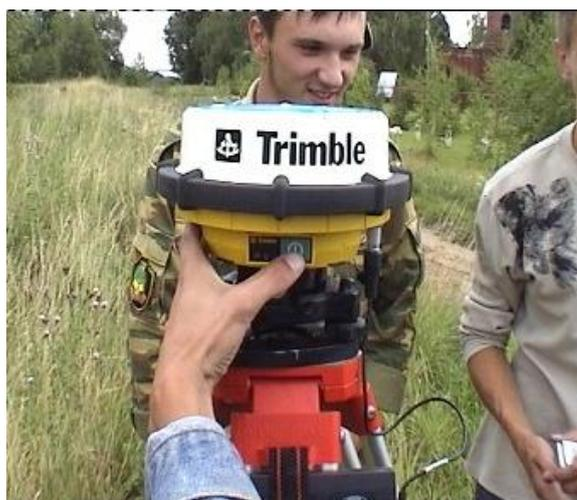
**Рис. 1.43. Включение приемника**
