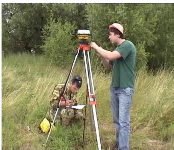
**Рис. 1.42. Измерение высоты антенны**
