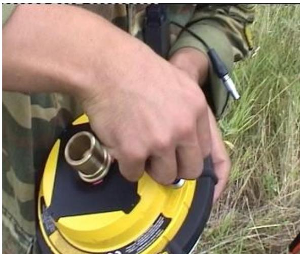
**Рис. 1.40. Соединение антенны с приемником**
